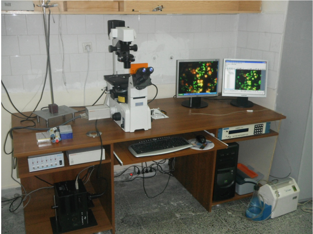
Şekil 4. Floresan Kalsiyum Görüntüleme Sisteminin Fotoğrafik Görünümü.
