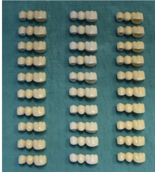
Şekil 3.3. Markalara göre gruplandırılmış monolitik zirkonya örnekler (Sırasıyla BruxZir, FireZr, Upcera)
