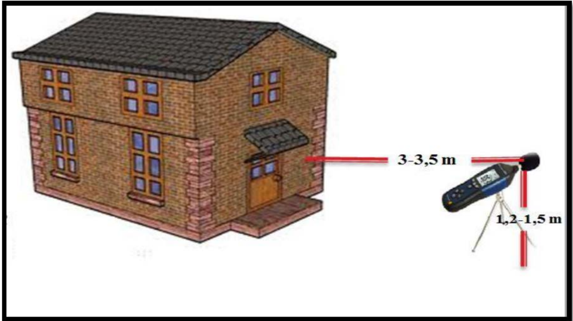
Şekil 3.1. Dış mekânda mikrofon konumu (ÇYGM, 2011).
