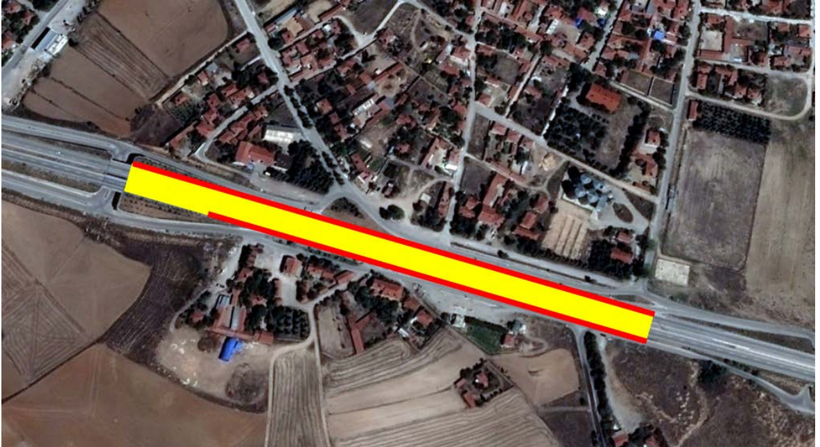
Şekil 5.1. Kaymaz Mahallesi geçişinde D200 yolu üzerinde yapılması önerilen Poroz Asfalt (sarı taralı alan) ve Gürültü Duvarı (kırmızı çizgiler) gösterimi
