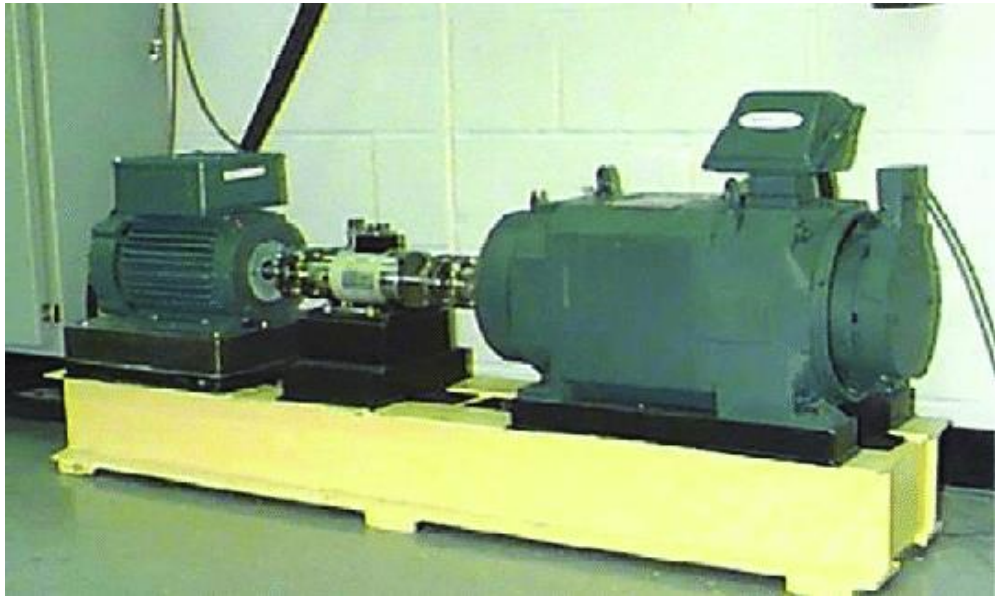
Şekil 3.1. CWRU veri seti elde etmek için kurulan test düzeneği (Loparo’dan, 2018)
