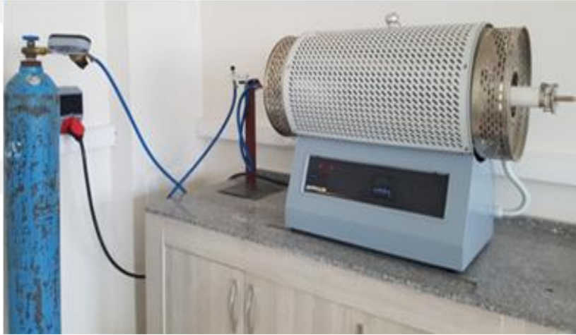
Şekil 4.2. Preslenen ham numunelerin sinterlenme düzeneği
