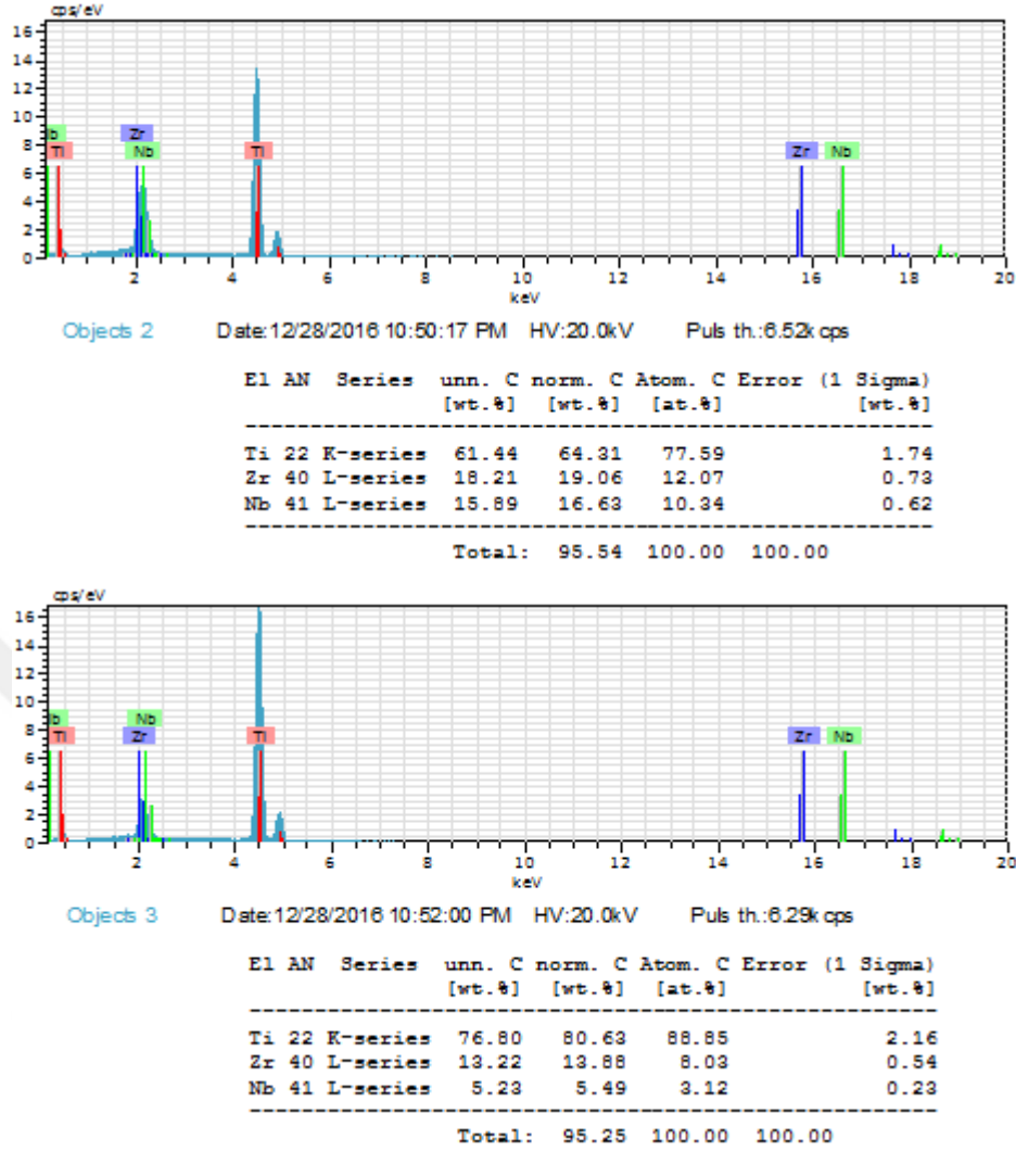
Şekil 5.4. 100 MPa basınçla kompaktlandıktan sonra 1200 °C sıcaklıkta 2 saat süreyle sinterlenen TiNbZr numunesinin SEM görüntüsü ve EDX desenleri. Yukarıdan aşağı doğru SEM görüntüsü, object1; orta bölge, object2; sol bölge ve object3; yukarı bölgelerin EDX desenleridir
