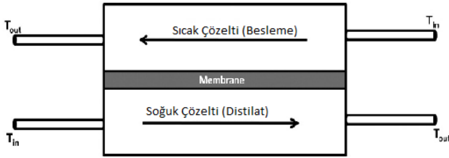
Şekil 3.8 Direkt temas membran distilasyonu (DCMD)
