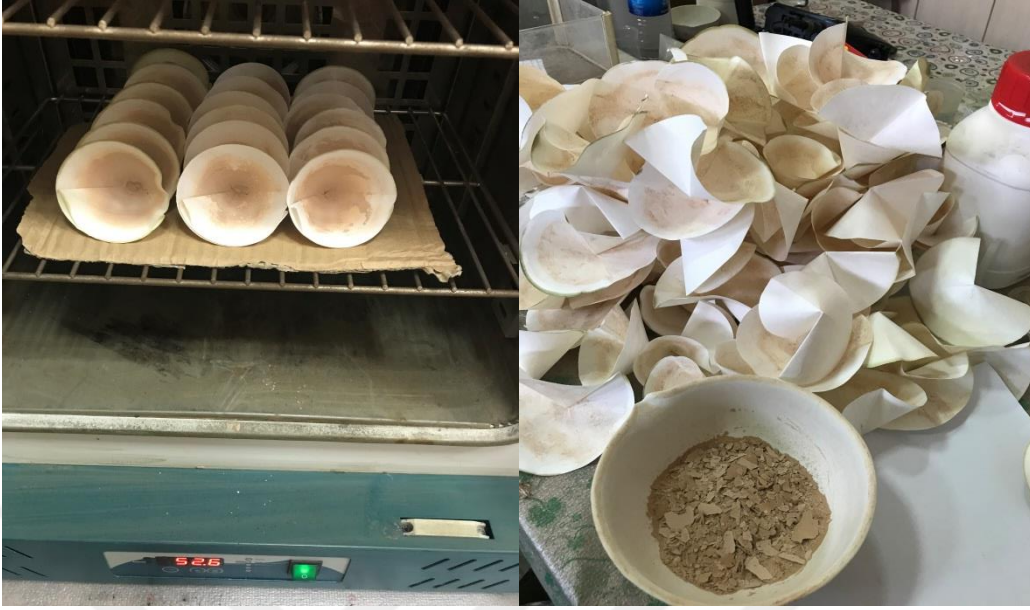
Şekil 5.6. Birinci aşamada biriktirilmiş olan liç bakiyelerinin kurutulması ve süzgeç kâğıdından sıyırılması
