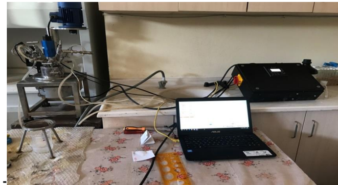
Şekil 5.9. İkinci aşama basınç liçi deneylerinin yapıldığı düzenek
