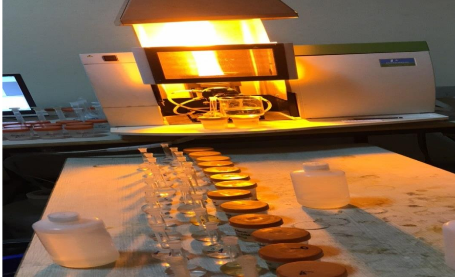
Őekil 5.8. özelti ierisindeki Fe ve Al metal analizlerinin yapılması
