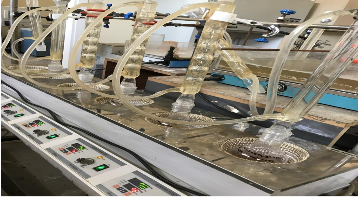
Şekil 5.4. Birinci aşama liç deneylerinin yapıldığı düzenek
