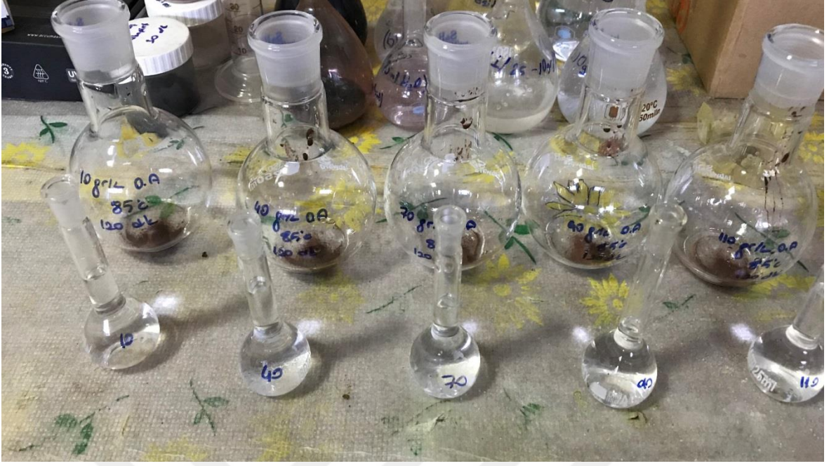
Şekil 5.3. Birinci aşama liç çözeltilerinin hazırlanması
