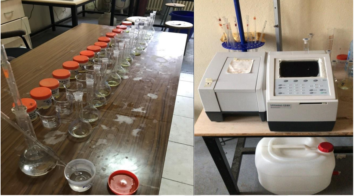
Őekil 5.7. özelti ierisindeki Ti analizleri iin kompleks oluřturma ařaması ve UV spektrometresi analiz cihazı
