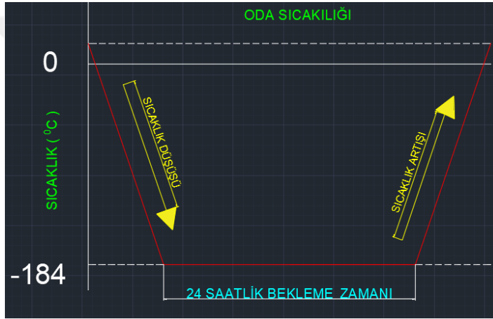
Şekil 5.8. Elektrotlara uygulanan kriyojenik çevrim
