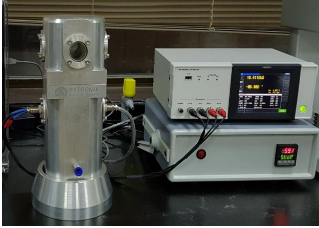
Şekil 5.9. Elektriksel iletkenli ölçüm ve analiz cihazı
