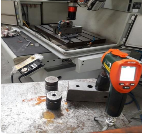
Şekil 5.5. Elektrotlarda oluşan sıcaklık değeri ölçüm yöntemi
