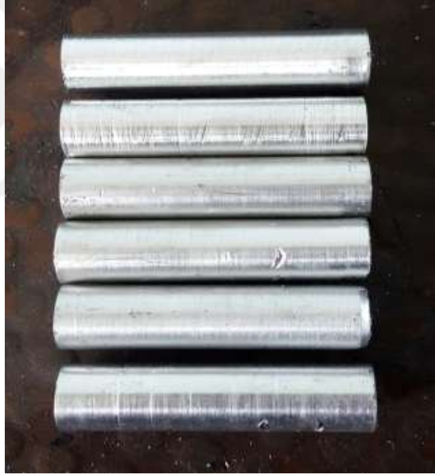
Şekil 4.11. Kaplama öncesinde hazırlanan alüminyum numuneler
