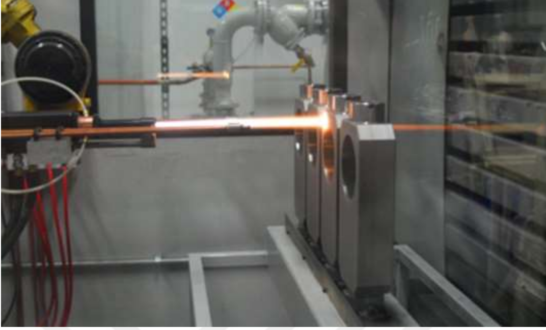
Şekil 2.4. Yüksek hızda oksijen-yakıt püskürtme yöntemi kullanılarak yapılan karbür kaplama işlemi [42]
