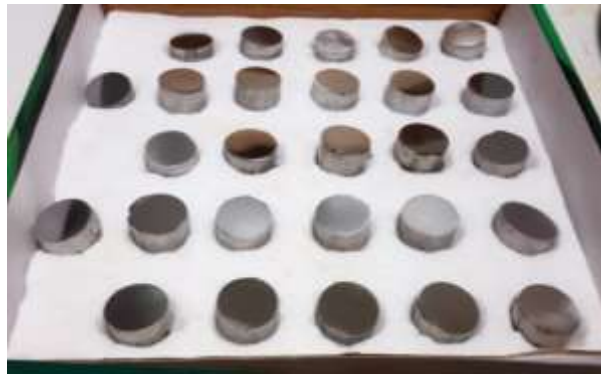
Şekil 5.2. Mikroyapı incelemeleri için hazırlanan numuneler
