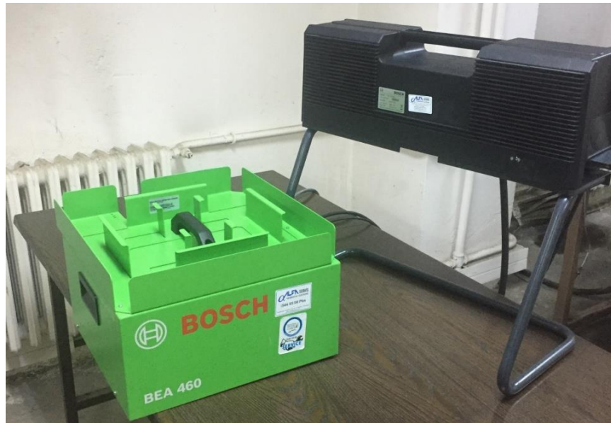
Şekil 5.6. Bosch BEA 460 marka egzoz emisyon ve duman koyuluk cihazı
