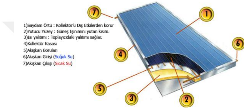
Şekil 3.4. Kolektör elemanları [20].
