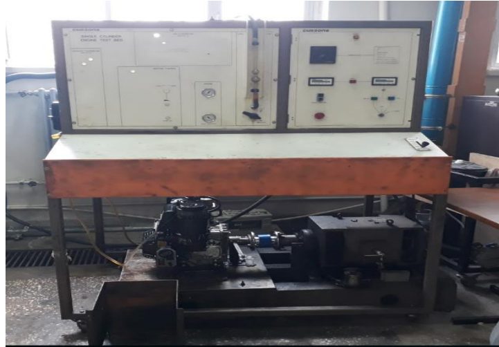
Şekil 5.2. Cussons P8160 motor test düzeneği
