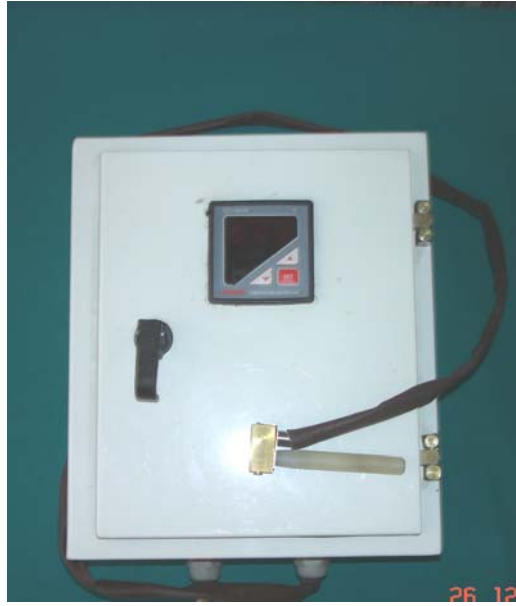
Şekil 3.17. Geri çekme reflekslerini deęerlendirmede kullanılan ısı test cihazı
