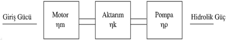
Şekil 2.2. Pompa Verim Kayıpları (TTMD)
