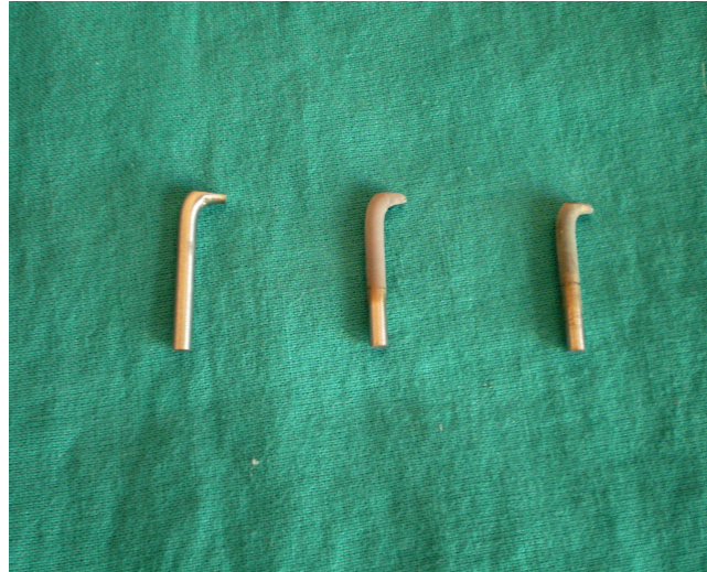
Şekil 3.2: Kaplanmamış Ti6A14V implant, HA kaplanmış Ti6A14V implant, ABT kaplanmış Ti6A14V implant
