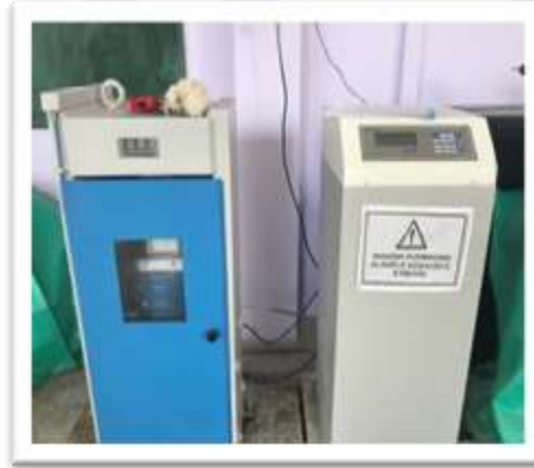
Şekil 5.6. Basınç ve çekme dayanımı deney düzeneği
