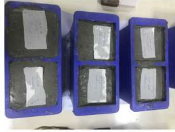
Őekil 5.4. Kalıplara d k len har numuneleri
