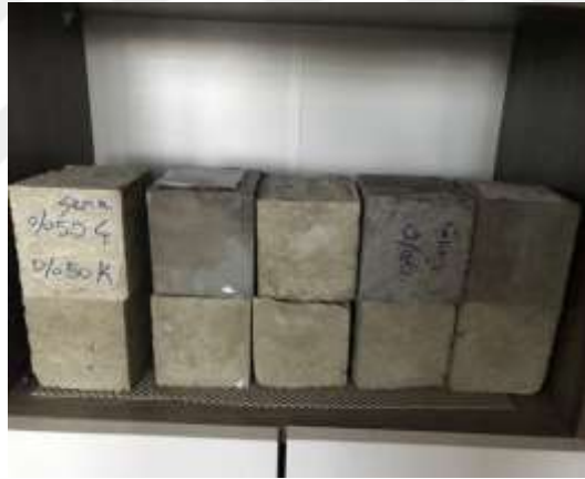
Őekil 5.5. Kalıplardan ıkartılan beton numuneler
