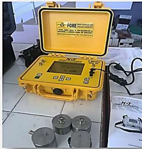
Şekil 5.13. Ultrasonik test cihazının görünümü ve şematik diyagramı
