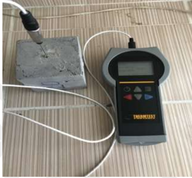
Şekil 5.15. Isı iletim katsayısı ölçümü alınan beton numune
