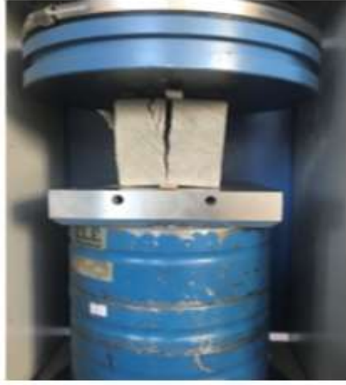
Şekil 5.8. Yarmada çekme dayanımı deney düzeneği
