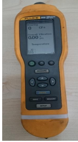
Şekil 4.23. Fluke 805 marka titreşim ölçer cihazı
