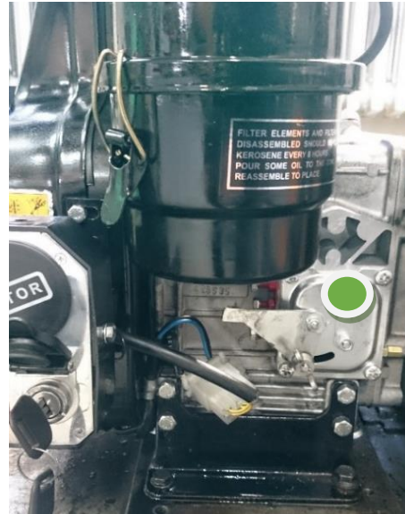
Şekil 4.24. Deney motoru üzerinde belirlenen titreşim ölçüm noktası
