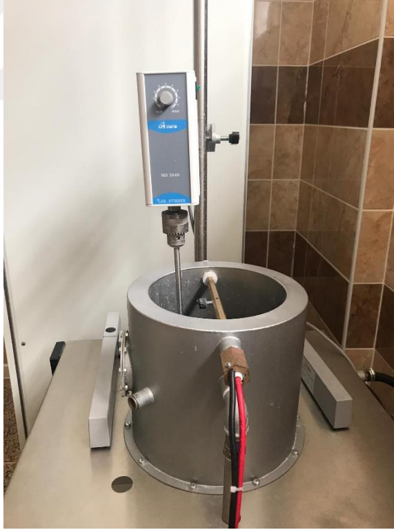
Şekil 3.7. Paslanmaz çelik tankın karıştırılmasında ve soğutulmasında kullanılan mekanik karıştırıcı
