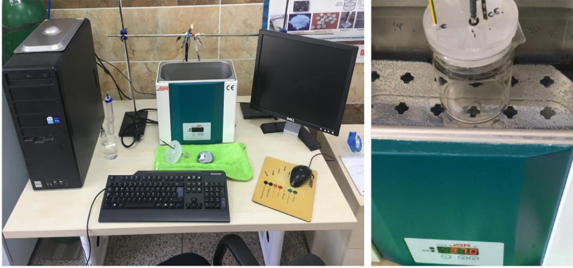
Şekil 3.10. Potansiyostat / galvanostat (Gamry, PCI14 / 750) ekipmanı korozyon hücresi
