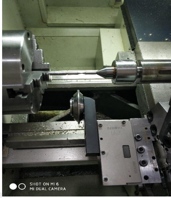
Şekil 5.4 BSD torna tezgâhında haddeleme işleminin uygulanması
