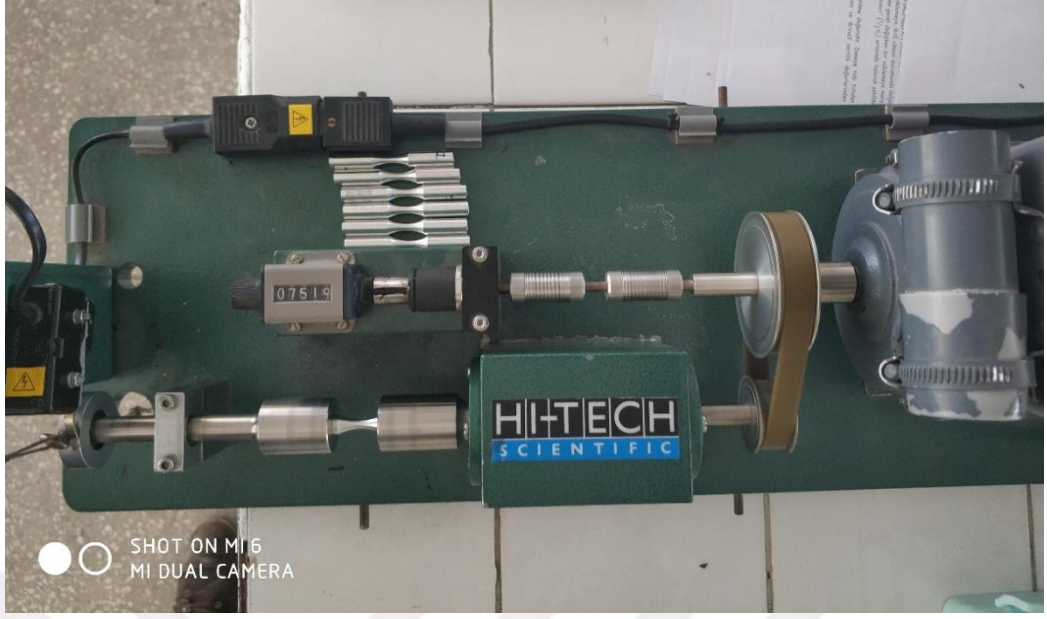
Şekil 5.5 Yorulma test cihazına yorulma numunesinin bağlanması
