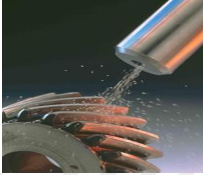
Şekil 3.2 Bilyeli yüzey dövme işleminin gösterimi [34].
