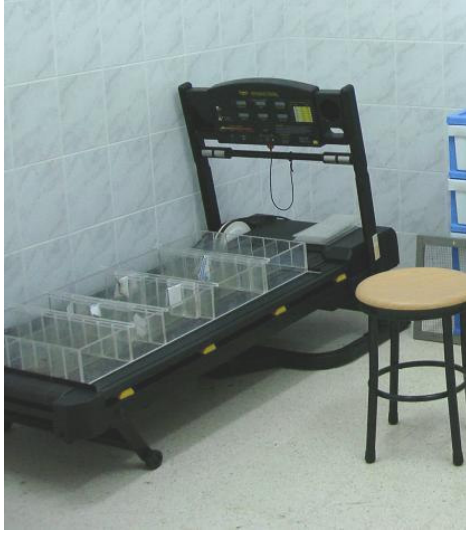
Şekil 7. Deneklerin egzersiz programına alındığı koşu bandı (a) ve deneklerin palet üzerinde yerleşimini sağlayan bireysel bölmeli palet üstü kabin sistemi (b).
