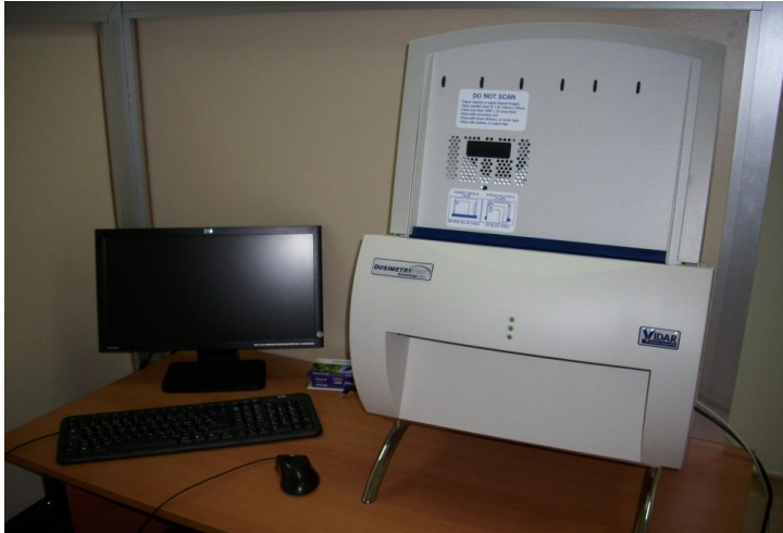
Şekil 18. Dansitometre bilgisayarı ve lazer tarayıcısı
