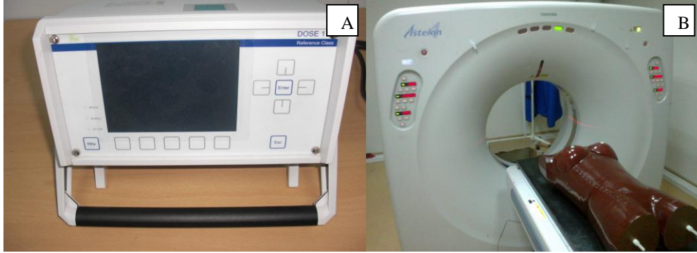
Şekil 12. A-Scanditronik Wellhöfer Dose1 marka elektrometre B-Toshiba Asteion BT ünitesi
