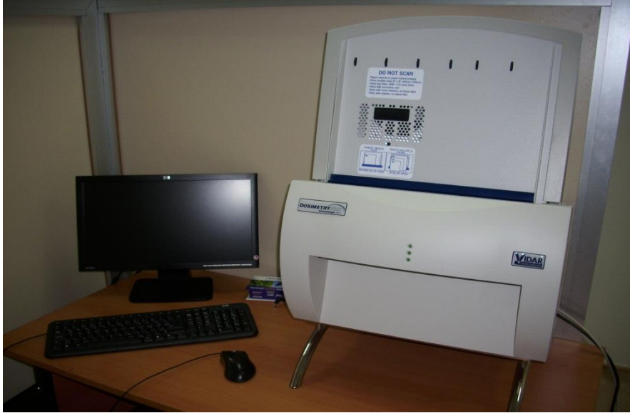
Şekil 15. Dansitometre bilgisayarı ve lazer tarayıcısı
