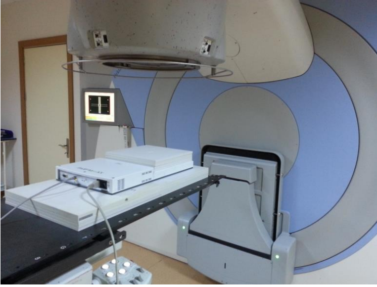
Şekil 40. Linak cihazında 2D-Array ile ölçüm düzeneği
