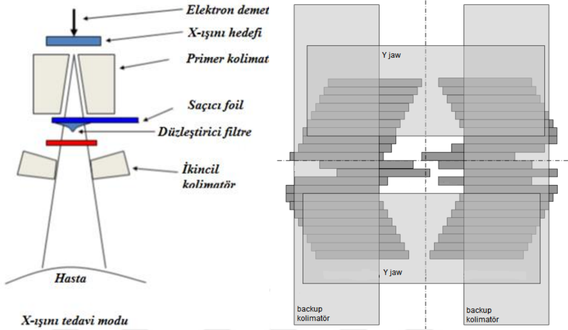
Şekil 8. Lineer hızlandırıcı ışınlama kafasında X-ışını modu (42)
