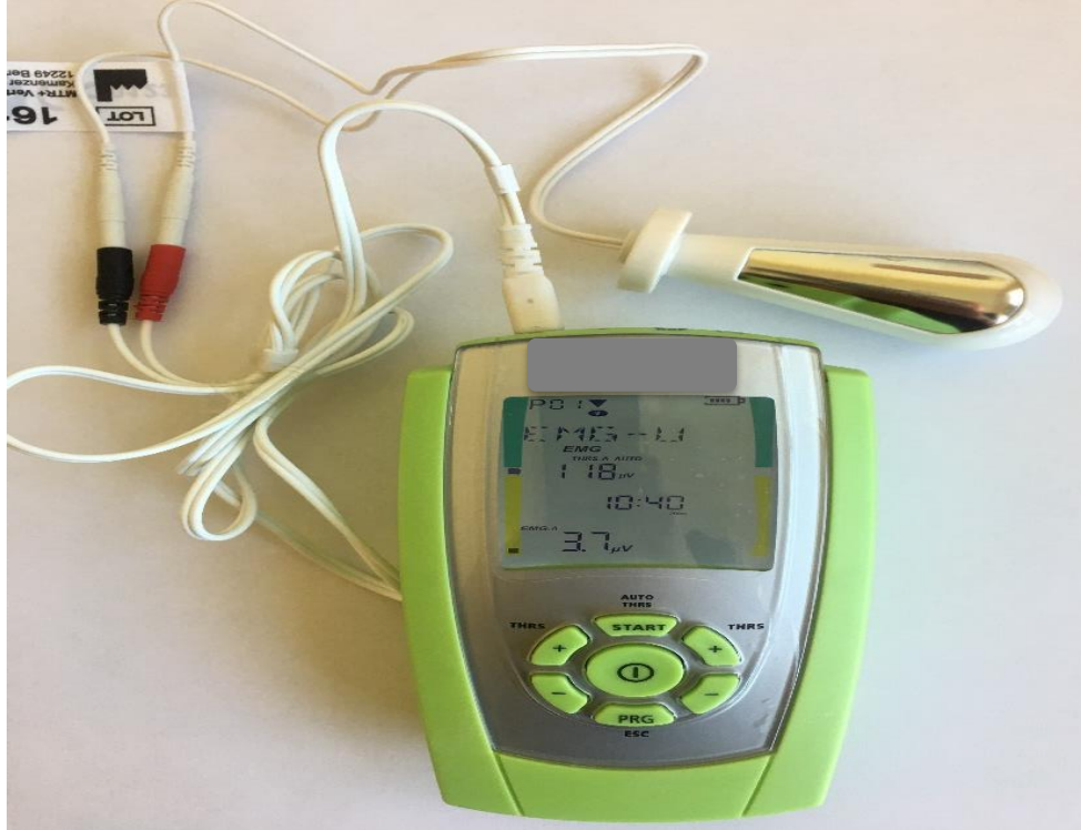
Şekil 6. Pelvik taban kas gücü ölçümü yapan ev tipi biofeedback cihazı
