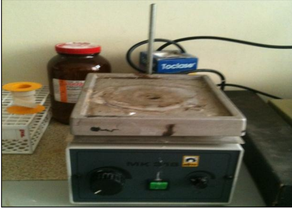
Şekil 23. Kimyasal sıvıların hazırlanması için kullanılan manyetik karıştırıcı.
