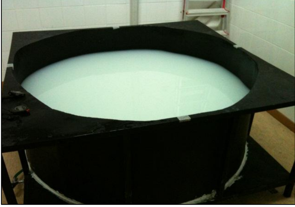
Şekil 20. Deneye hazır hâle getirilmiş Morris Su Labirent Tankı.
