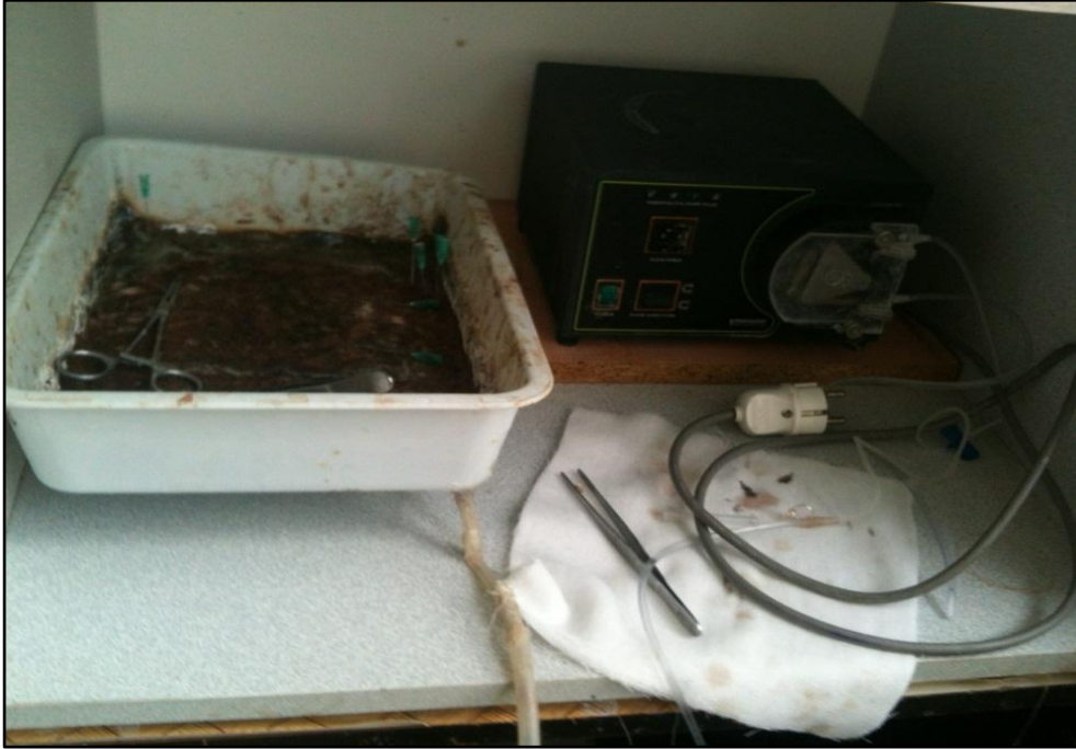
Şekil 24. Deneyde kullanılan perfüzyon seti.
