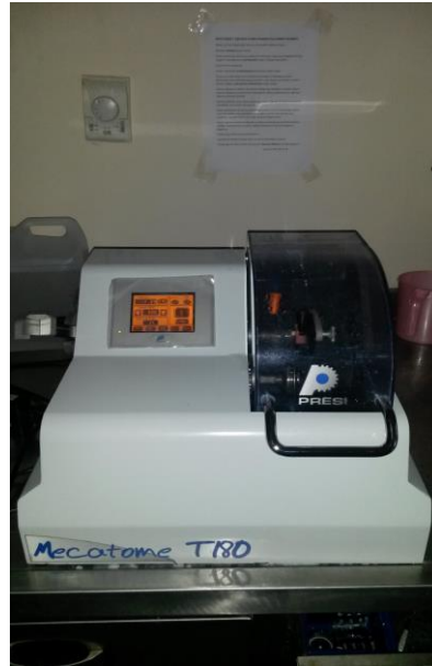
Şekil 2.22. Çalışmamızda kesme cihazına sabitlenmiş ve 1 mm kalınlığında kesit alınacak şekilde ayarlanmış bir örnek.
