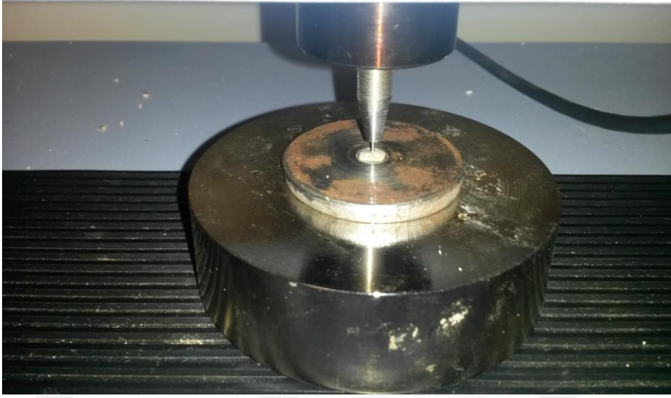
Şekil 2.26. Çalışmamızdaki bir örneğe ait push-out test düzeneği
