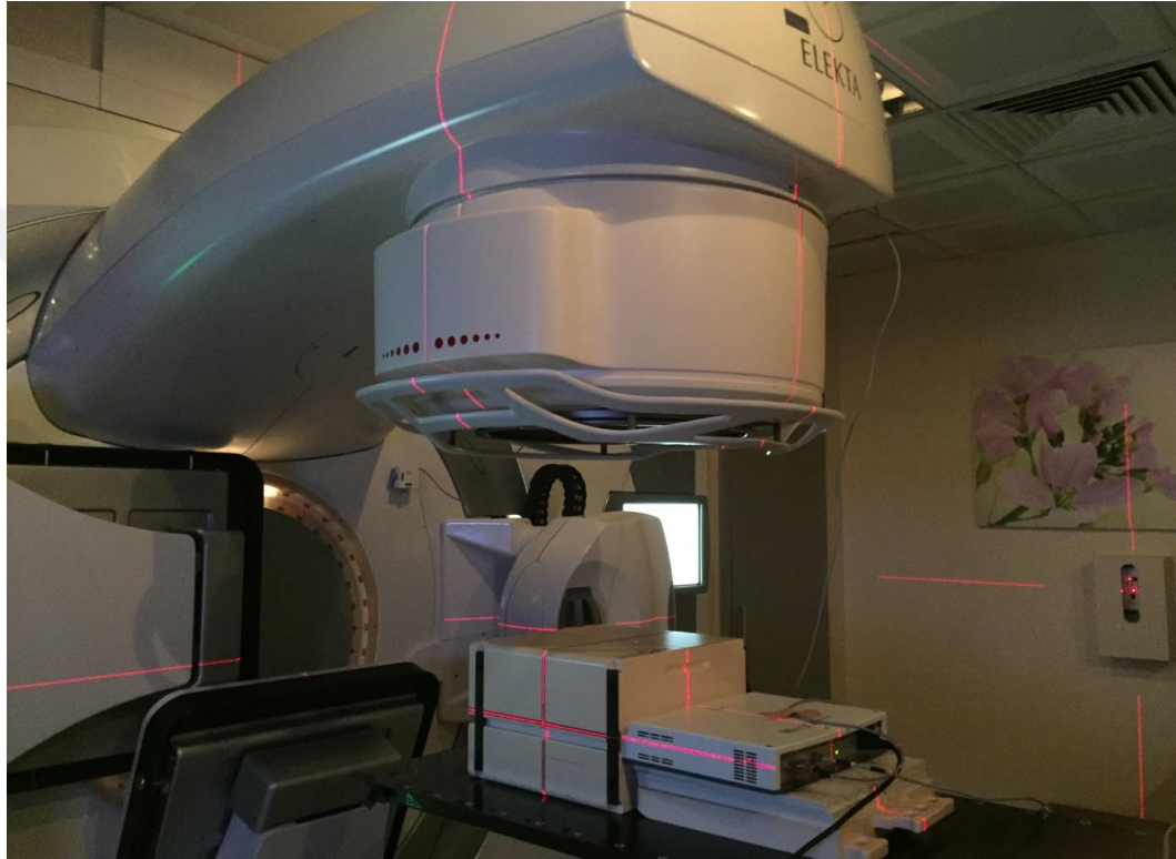
Şekil 27. Tüm hastalar için IMRT MatriXX 2D-Array ile yapılan dozimetrik kalite kontrol ölçüm düzeni
