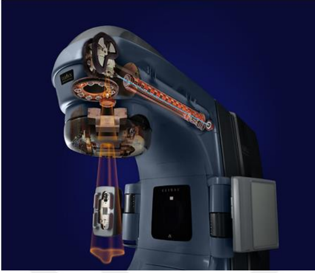
Şekil 2. a) Lineer akseleratör cihazı b) Seçilen radyasyonun türüne göre kolimatör sistemindeki elemanların konumlanması (5)
