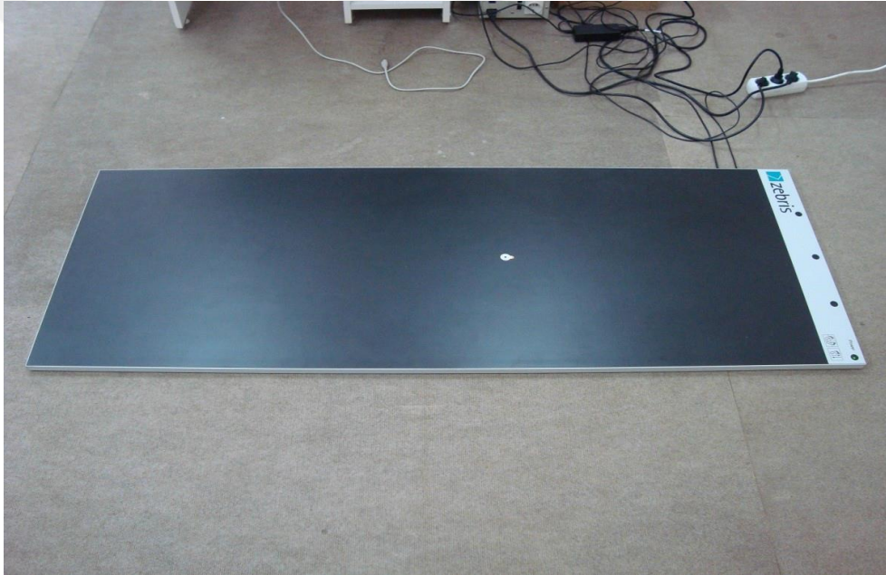
Şekil 7. Postüral kontrol değerlendirmesinde kullanılan basınç platformu (Zebris© FDM System Type FDM 1.5)
