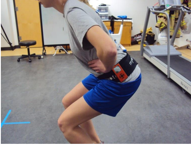
Şekil 10. Taşınabilir 3D dikey sıçrama ölçüm cihazı(85)
