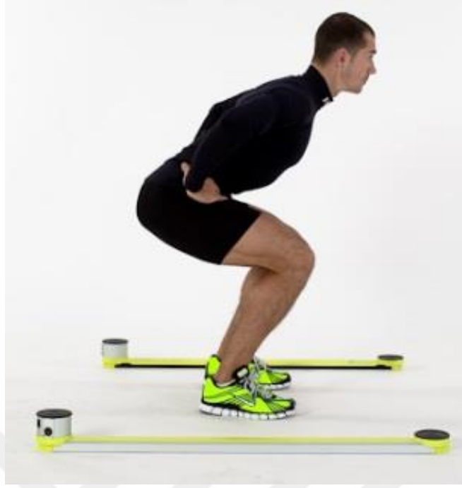
Şekil 9. Fotoelektrik hücreli sistem ile dikey sıçrama ölçümü(82).
