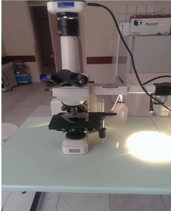
Şekil 3.7. Morfometrik analizlerde kullanılan izim tüpü ataşmanlı ışık mikroskobu
