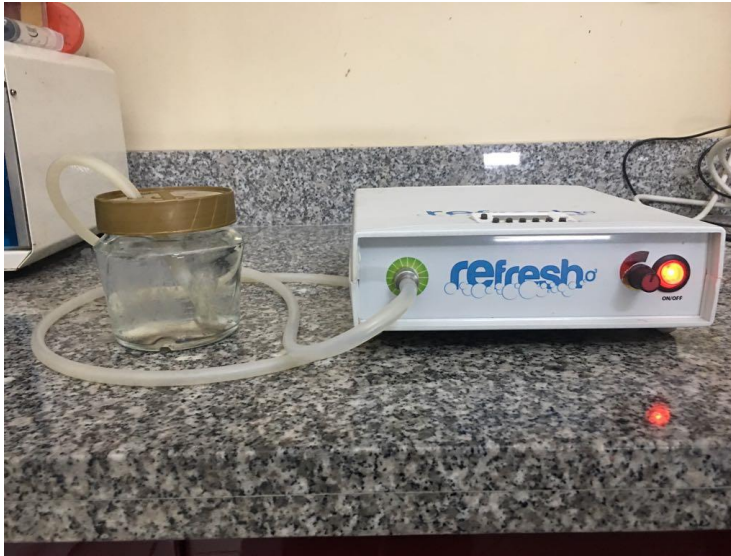
Şekil 2.3.c: Ozonlu suyun hazırlanışı.
