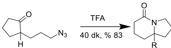
Şekil 31. Alkil azidlerin intramoleküler Schmidt reaksiyonu genel reaksiyon denklemi (80)
