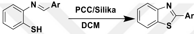
Şekil 8. Silikajel üzerinde PCC varlığında, tiyofenolik ve fenolik schiff bazlarının oksidatif siklizasyonu ile 2-arilbenzotiyazol sentezi (29)
