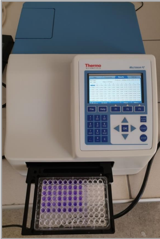
Şekil 24. Kontrol plaklarında biyofilm oluşumunun kristal viyole doğrulanması ve ELISA reader'da OD ölçümü ile değerlendirilmesi
