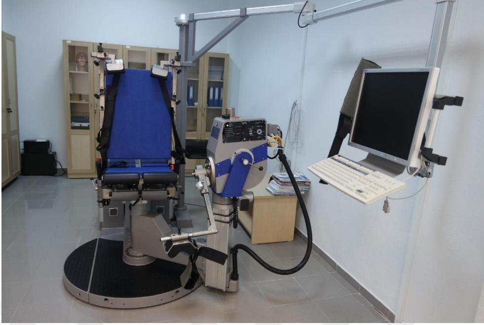
Şekil 3.6 Isomed2000 (D&R Ferstl GmbH, Hemau, Germany) Marka İzokinetik Dinamometre
