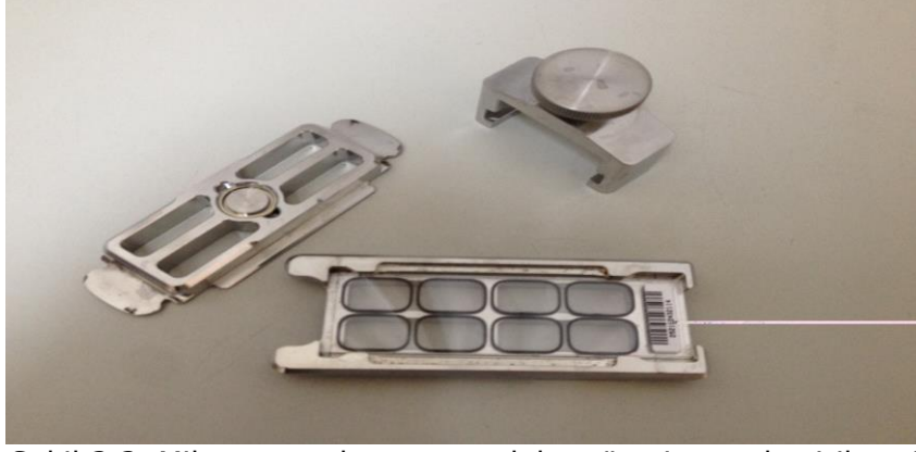
Şekil 3.3. Mikroarray slaytın contalı lam üzerine yerleştirilmesi
