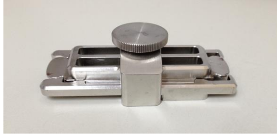
Şekil 3.4. Hibridizasyon fırınına (rotatora) yerleştirilmeden önce hibridizasyon haznesinin sıkıştırılması
