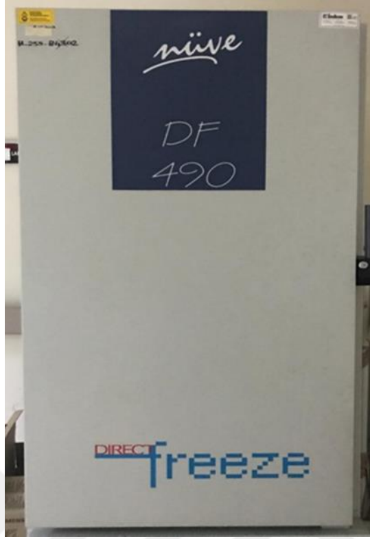
Şekil 2.4. Doku örneklerinin muhafaza edildiği -80 °C soğutucu.
