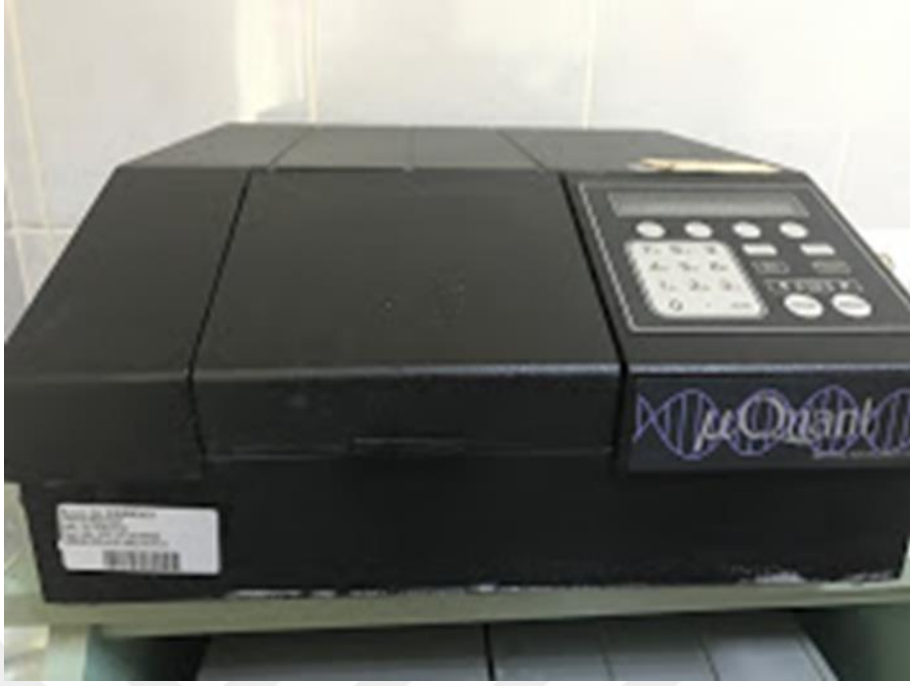
Şekil 2.13. BioTek Uquant MQx200 ELİSA okuyucusu.
