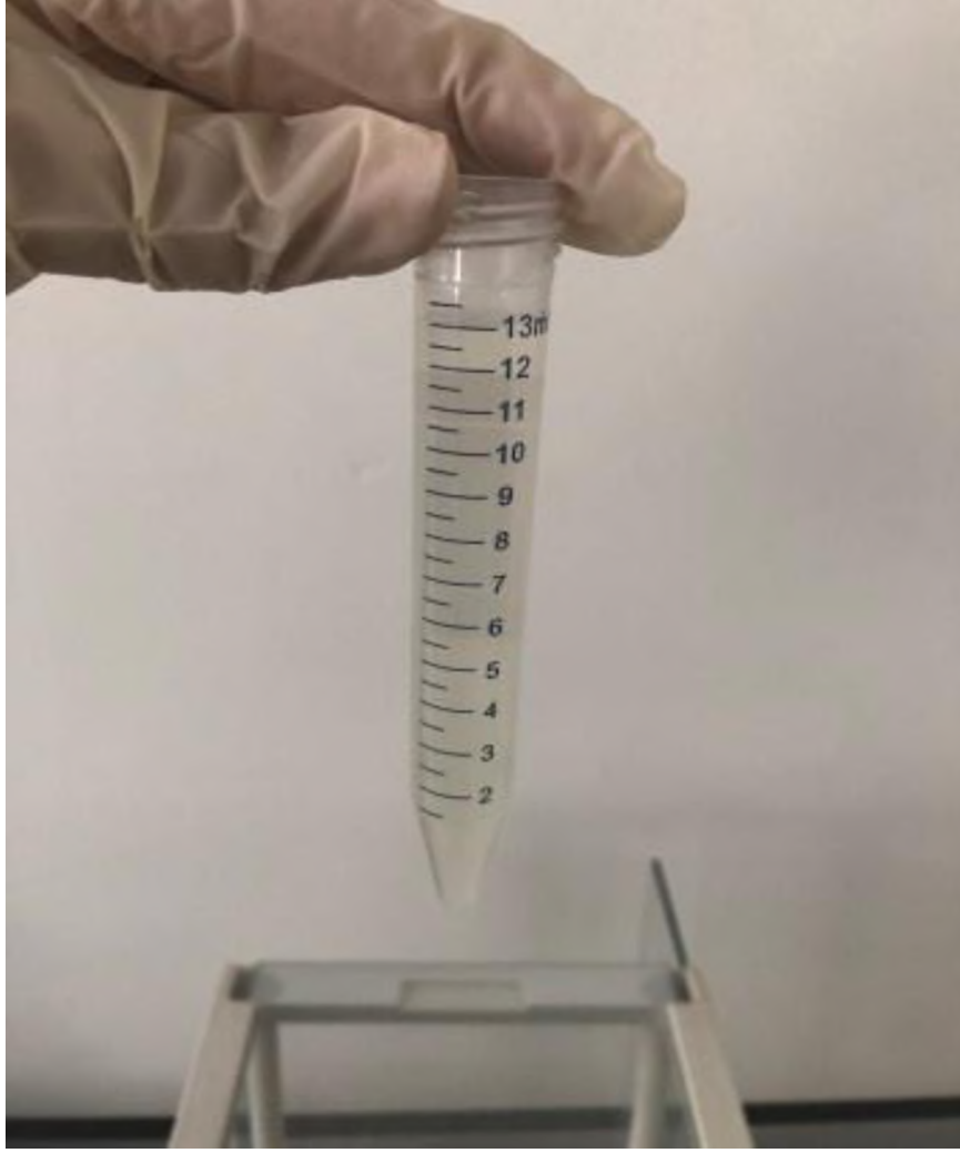
Şekil 10. Asitleme işlemlerinden sonra homojen olarak elde edilen ölçüme hazır dilüsyon.
