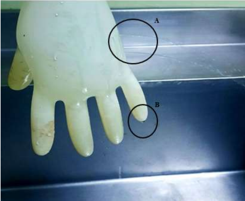
řekil 4. Delinme tipleri: A-řiddetli delinme, B-Sızıntı řeklinde delinme
