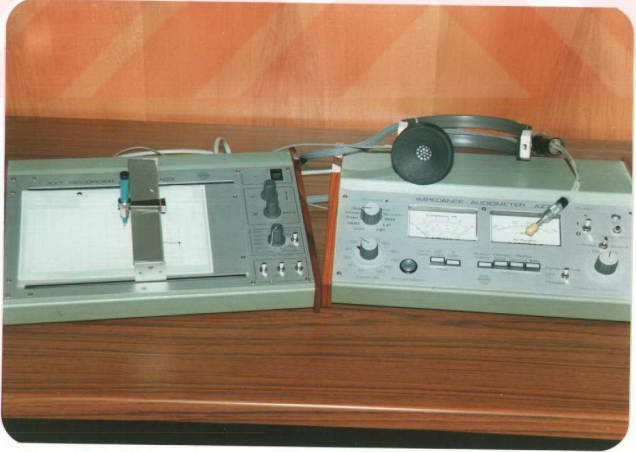
Resim 2- Çalışmada kullandığımız "Interacoustics AZ-7" impe- dans odyometresi ve onun "XYT recorder Model AG 3" tipi yazdırıcısı
