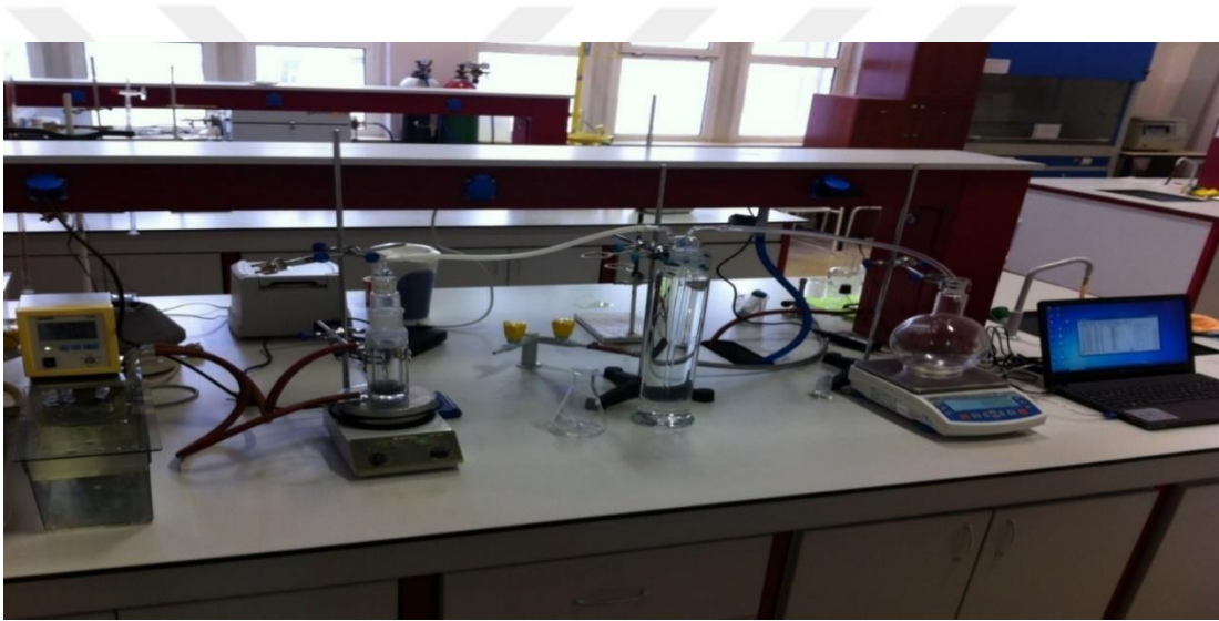
Şekil 6.1 Katalik aktivite test düzeneğinin fotoğrafı.
