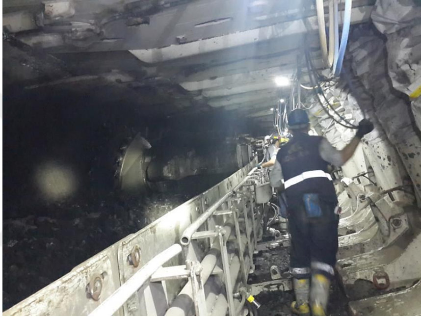
Şekil 5.3. Cat Electro 2000 kesici yükleyici makinesi.
