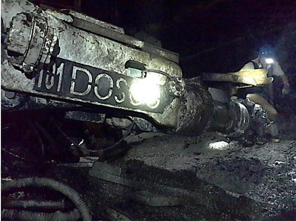
Şekil 4.4. Dosco marka kollu galeri açma makinesi.
