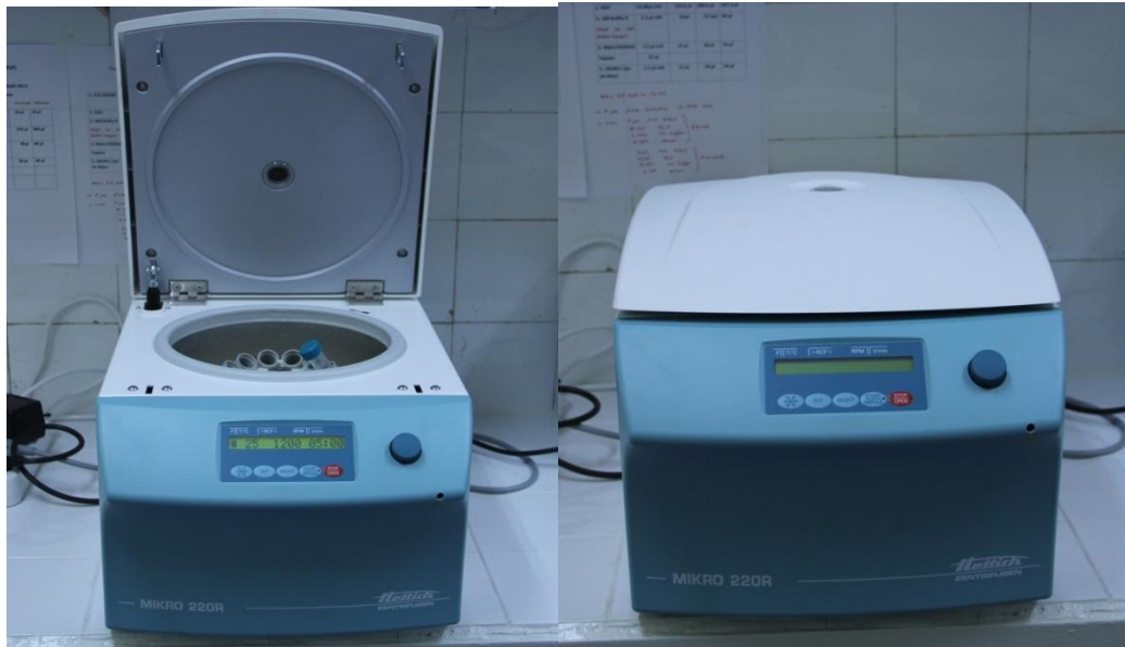
Şekil 3. 1 Hettich Mikro 220R Santrifüj Cihazı
