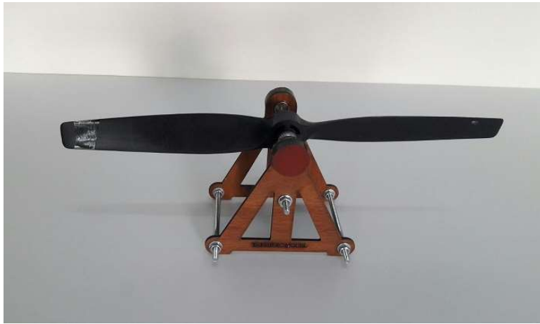
Şekil 3.5. Pervane balansı test düzeneği
