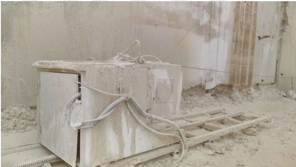
Şekil 5.12. Raylı elmas tel kesme makinası ve kesimi
