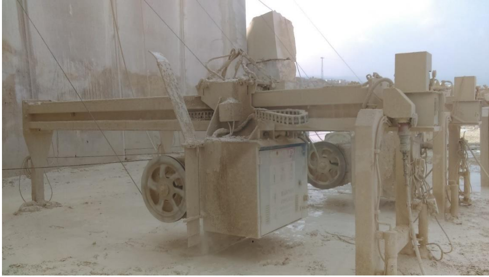
Şekil 5.11. Köprülü elmas tel kesme makinası ve kesimi
