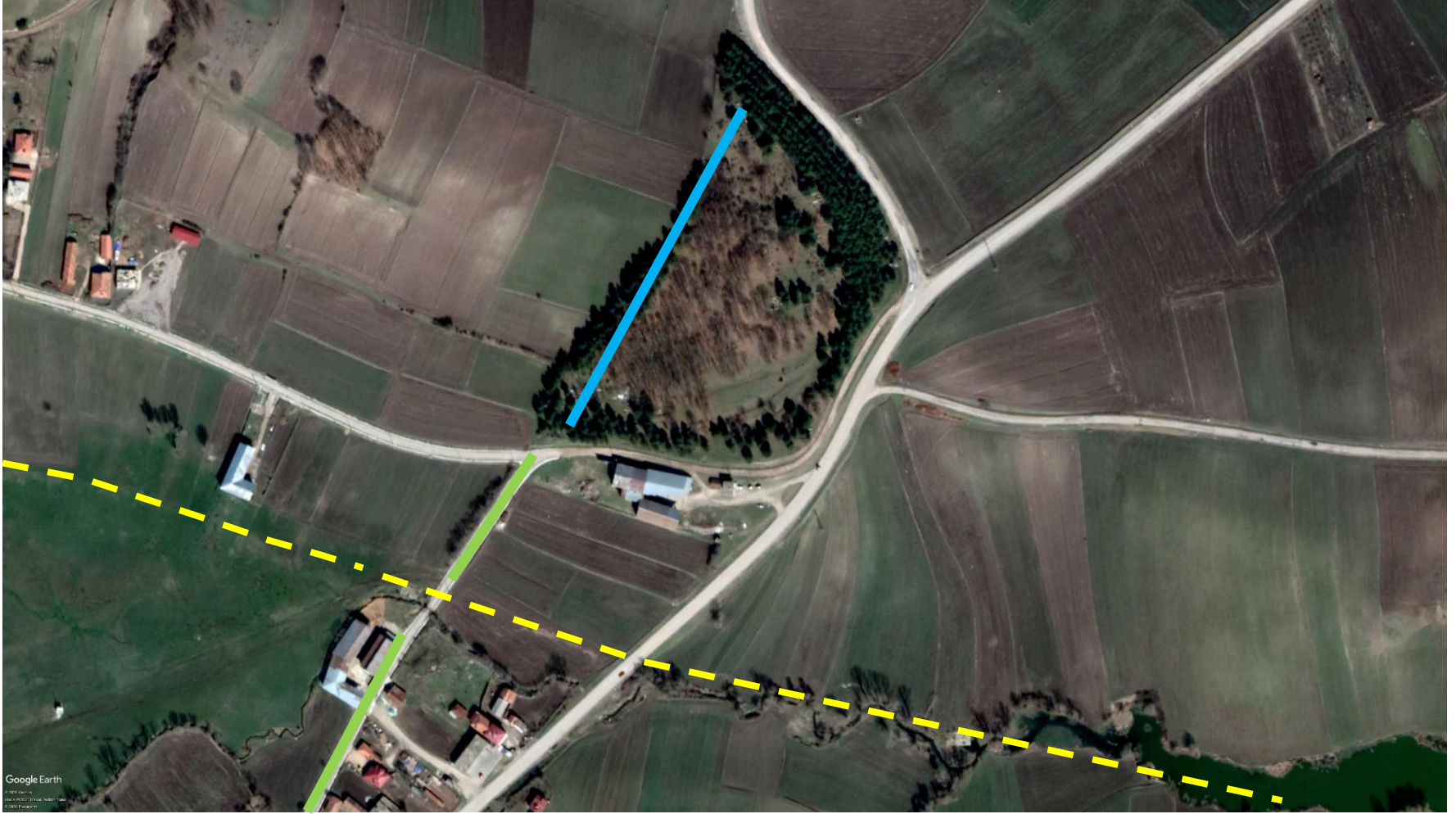
Şekil 5.20. Eski yolun Google Earth görüntüsü. Kesikli sarı çizgi fayın uzanımını göstermektedir. Yeşil çizgi günümüzde kullanılan asfalt yolu, mavi çizgi eski yolu göstermektedir.
