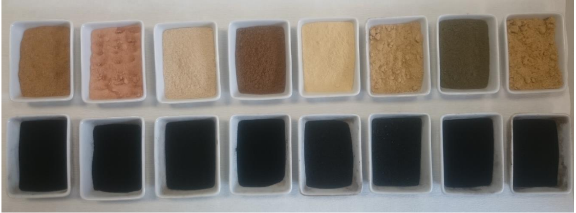
Şekil 7.1. Soldan sağa vişne sapı, süs elması, barbunya kabuğu, muz kabuğu, mandalina kabuğu, inci çalısı, zılbıt ve kırmızıbiber çekirdeği ile biyokömür formları
