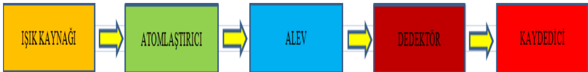
Şekil 8.1. AAS cihazının temel bileşenleri
