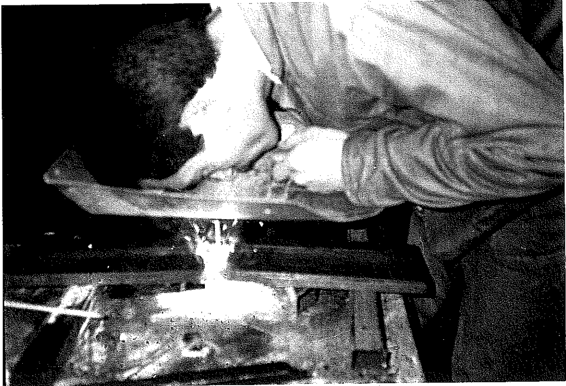
Sekil 6.18 Malzemeye elektrik ark kaynağı uygulanması.
